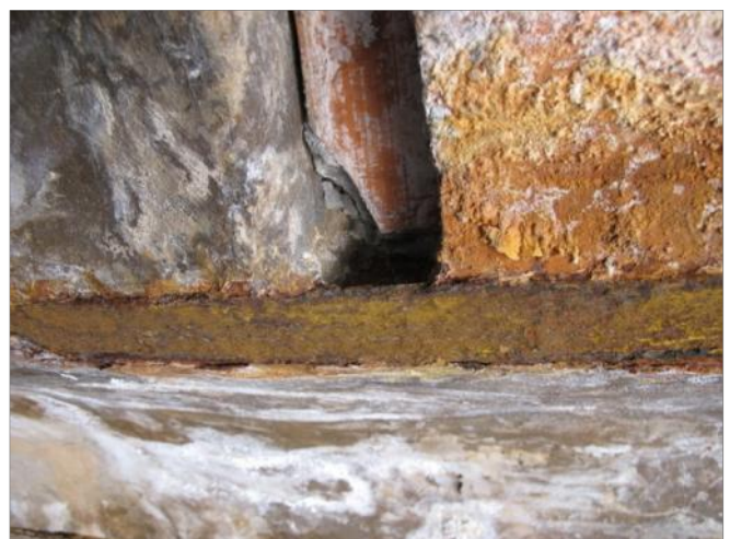
Figure 25 : Etat du té après élimination des produits de corrosion.
